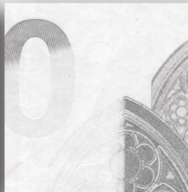
IR-Licht erfasst die IR-Reflexion einer Banknote
